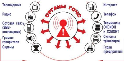
**СИСТЕМА ОПОВЕЩЕНИЯ ГРАЖДАНСКОЙ ОБОРОНЫ** — организационно-техническое объединение оперативно-дежурных служб, специальной аппаратуры управления и средств оповещения, обеспечивающих передачу сигналов гражданской обороны и речевой информации.
